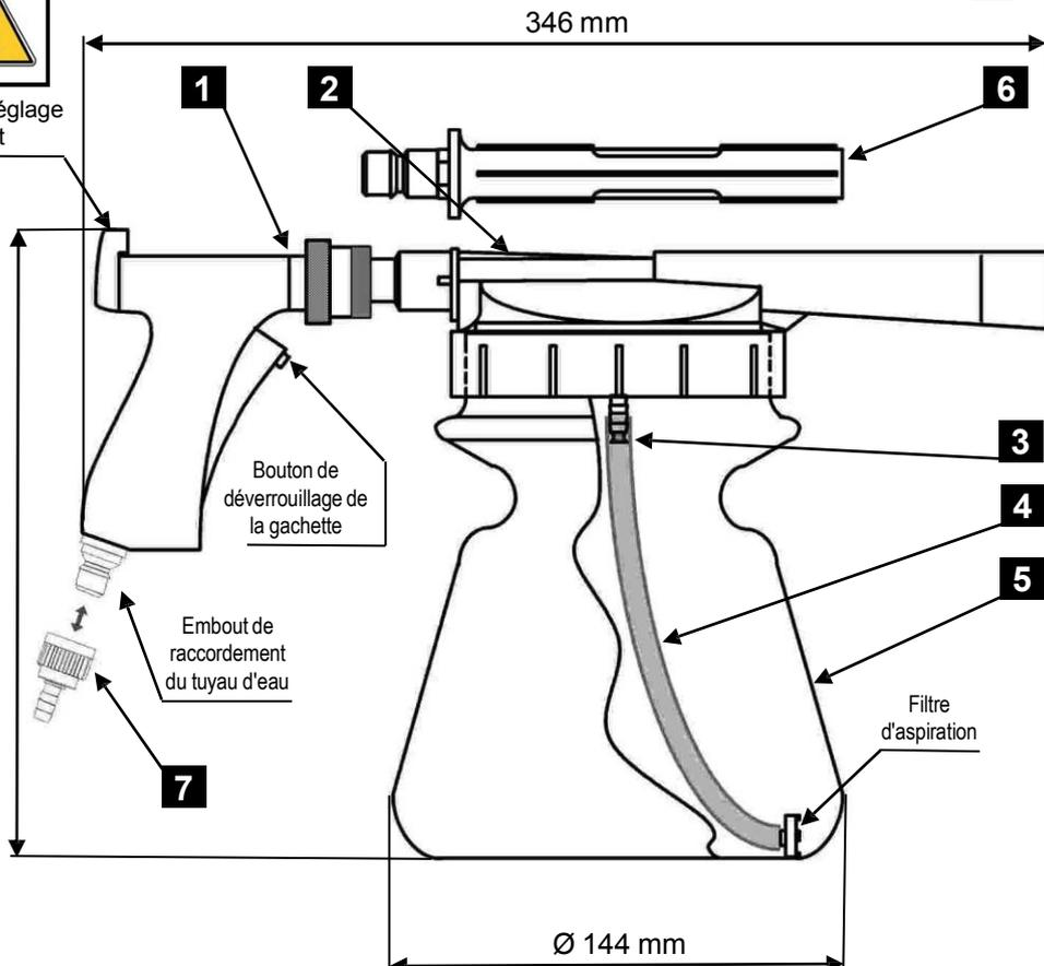
**La CENTRALE DE DILUTION MOBILE est destinée au nettoyage par application de mousse.**
